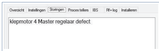
Afbeelding Servicetool Klepmotor niet gedetecteerd
